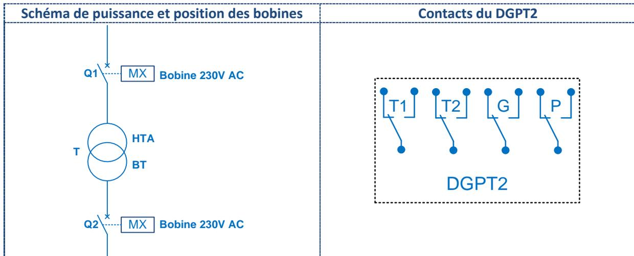
**Rappel :** Les bobines MX sont des accessoires qui peuvent équiper tous les disjoncteurs. Elles se montent sur le côté ou à l'intérieur des appareils suivant la puissance des disjoncteurs et permettent
